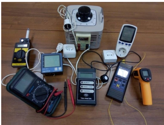
Рис. 3. Приборы, применяемые для изучения характеристик ламп
