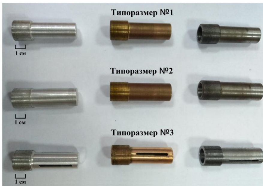
Рис. 4. Фото металлических экранов различного типоразмера
