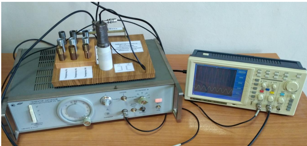
Рис. 7. Внешний вид лабораторного стенда по исследованию эффективности электромагнитных экранов в широком диапазоне частот
