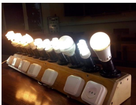
Рис. 1. Установка для экспресс-оценки цветовой температуры
