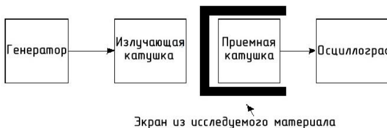
Рис. 5. Структурная схема лабораторного стенда
